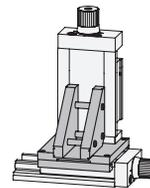
Verstelleinheit X-Y, Y-Schlitten mit Drehplatte GN 900.5 (siehe Seite 676) schräggestellt.
