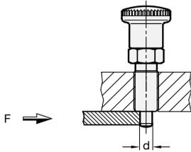
**Festigkeitsberechnung von Rastbolzen/ -riegel** für die Belastungsfälle Scherung / Biegung des Raststiftes
