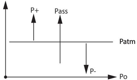
Druck bedeutet eine Kraft pro Flächeneinheit. Seine Maßeinheit ist das Pascal (Symbol Pa), wobei 1 Pascal dem Druck von 1 N (Newton) auf einer Fläche von 1 m<sup>2</sup> entspricht.
