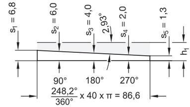
Auf den Zeichnungen ist beispielhaft die Form KV mit Spannrichtung R (durch Rechtsdrehung) dargestellt.
