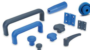
Thermoplast mit Einsätzen aus Edelstahl 1.4301, für Kontakt mit Lebensmitteln geeignet (FDA CFR.21 und EU 10/2011). Durch die spezielle blaue Farbe sind Verunreinigungen mit dem menschlichen Auge leicht erkennbar. Dies führt zu einer verbesserten Sicherheit in der Lebensmittelproduktion.
