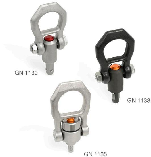
Neu im Programm hat Elesa+Ganter selbst-sichernde Gewindetragebolzen für Hebe-, Sicherungs- und Transportaufgaben. Überall, wo Werkstücke, Vorrichtungen oder Anlagenteile eine Gewindebohrung haben, lassen sich die neuen Gewindetragebolzen mit einem Handgriff als Anschlagpunkte einsetzen und ebenso leicht abnehmen. Sie sind die schnellere und praktischere Alternative zu Ringschrauben, Lastbügel und angeschweißten Ösen.
