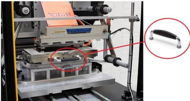
**Anwendung von MMT. Bügelgriffen an der HS K-Desk Präzisionsmaschine**
