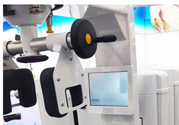
Anwendungsbeispiel der VDS+I Scheibenhandräder mit Sicherheits-Umleggriffen
